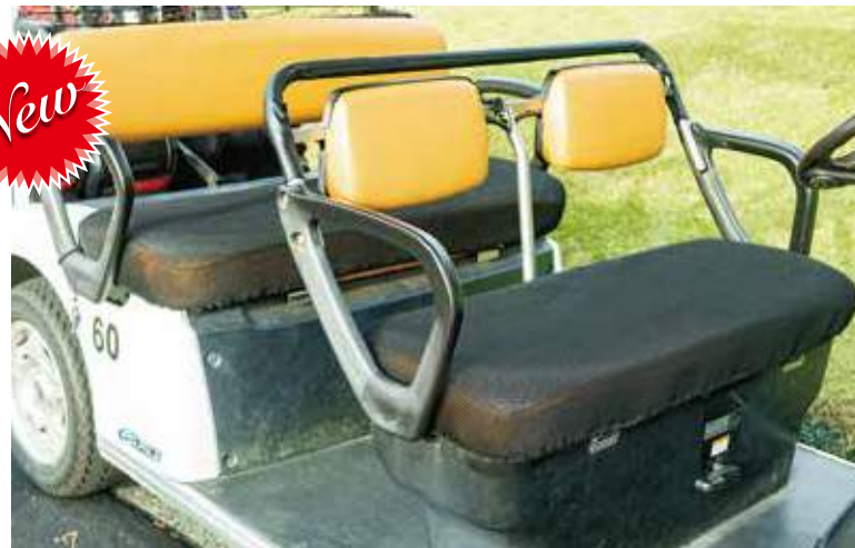
メッシュシート用保護カバー 厚手タイプ 5mm厚メッシュ生地 G3562・G3563 材 質：ポリエステル
